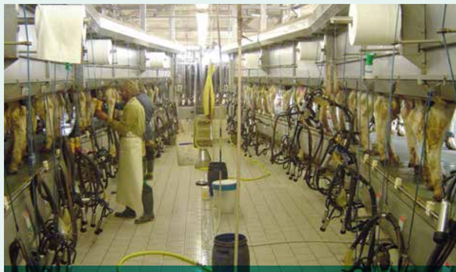
Figura 7 La disposizione a rombo delle due file di poste migliora la visibilità dei gruppi di mungitura e delle bovine nelle sale parallele di grandi dimensioni.
